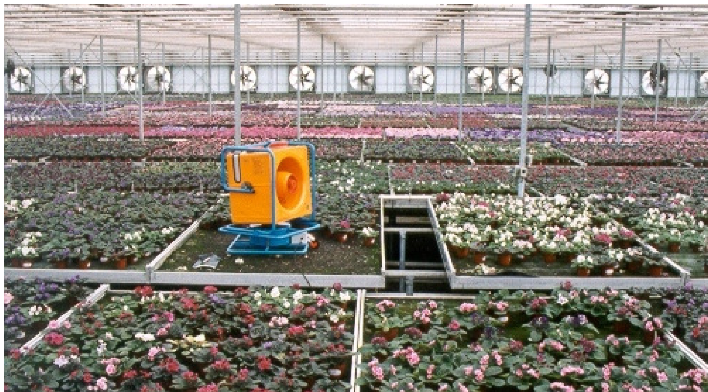
Turbomatic připravený k postřiku třásněnek. Počítačem řízený otočný stůl umožňuje naprogramovat několik směrů rozprašování.
